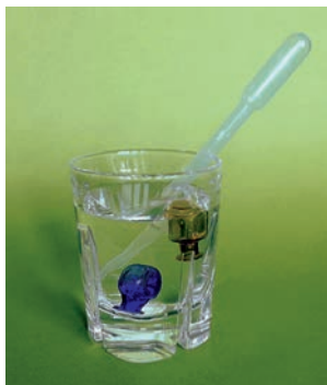
Рис. 4. Плаваемость регулируем в отдельном стакане
